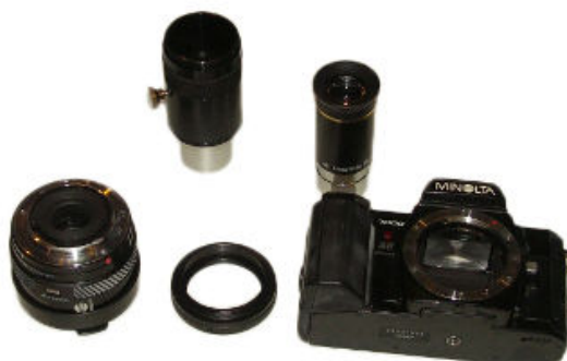
Rys. 2 Odkręcamy obiektyw lustrzanki
