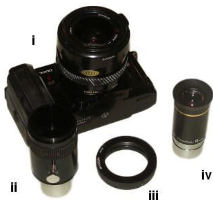
Rys. 1 (i) lustrzanka Minolta AF z założonym obiektywem, (ii) złączka typu camera adapter z możliwością projekcji okularowej, (iii) pierścień pośredniczący T2 dla Minolta AF / Sony Alfa, (iv) okular
