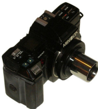
Rys. 5 Lustrzanka z wkręconym adapterem fotograficznym przygotowana do fotografowania w ognisku zwierciadła
