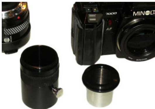
Rys. 4 Złączka projekcyjna rozkręcona - po prawej 1,25" / T2 (stosowana do fotografowania w ognisku), po lewej tuleja projekcyjna
