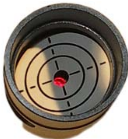
Rys. 4 Widok na kolimator z dołu, widoczna wiązka laserowa
