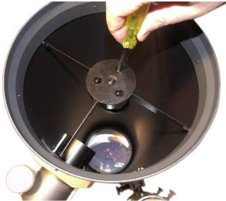
Rys. 8 Regulacja położenia lusterka wtórnego – na lustrze głównym widoczna czerwona plamka wiązki laserowej
